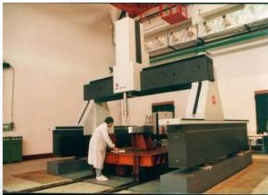
Координатно-измерительный станок Zeiss CMM 4*4*3m
