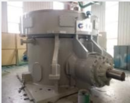
Редуктор угольной мельницы
