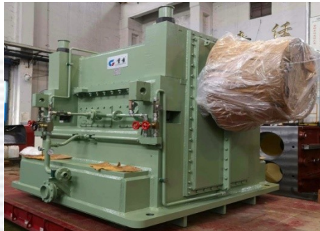
Редуктор клетки алюминиевого прокатного стана (BAOWU)
