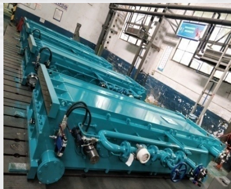
Распределительный редуктор (SMS)
