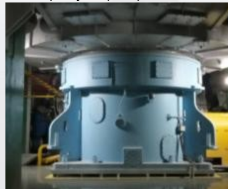
Параллельно-цилиндрический редуктор серии JLP
