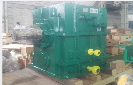
ESP Редукторы намотки (Производство настоящей бесконечной ленты-Primetals)
