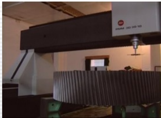
Координатно-измерительный станок Hexagon CMM 3*3*1m
