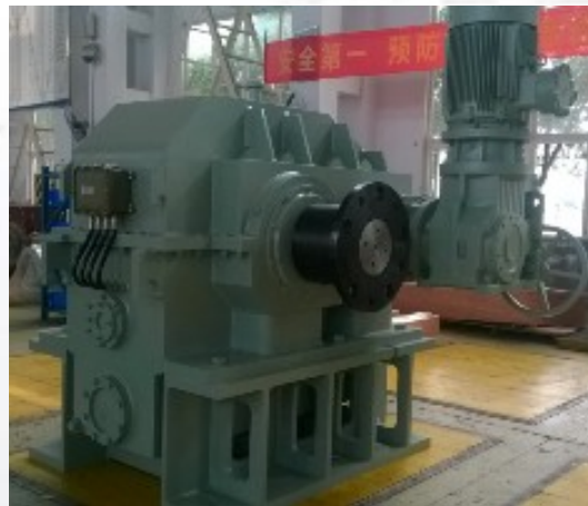
Редуктор серии GS с поворотным механизмом и насосом
