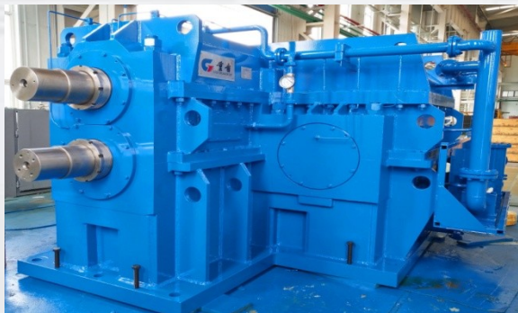
Комбинированный Редукторы в прокатных станах (Бень Сталь)
